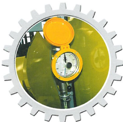
Pompa acqua autodescante con contaltri Self-priming water pump with water-meter Pompe à eau automorçante avec compte-litres Bomba de agua con cuenta-litros
