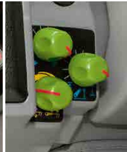
Funkci EHR lze nastavit snadno a jednoduše pomocí otočných ovladačů
