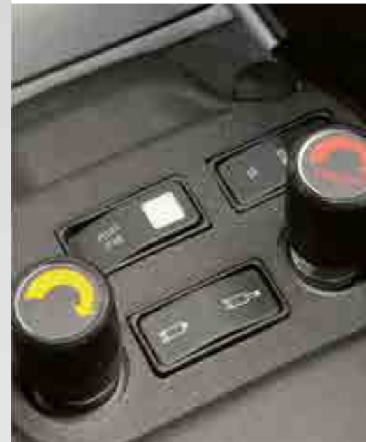
Elektrohydraulická boční stabilizace a regulace průtoku pro připojené příslušenství
