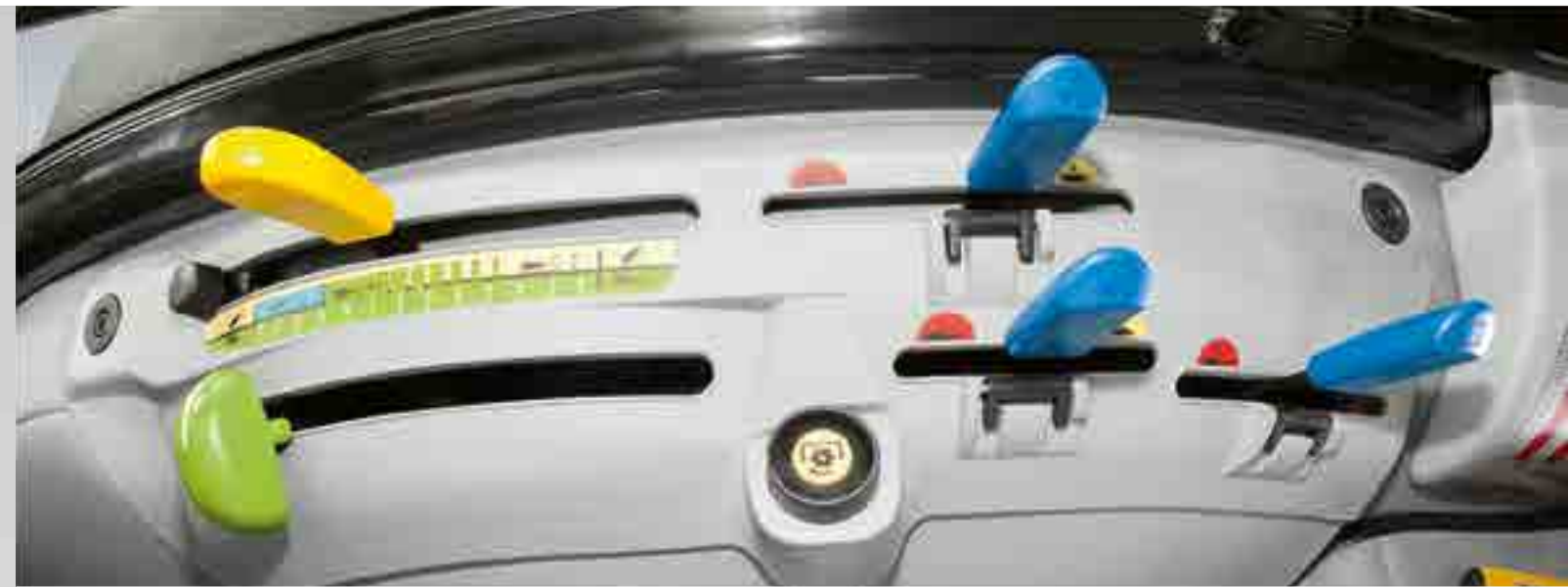
Logicky umístěné mechanické ovládání závěsu patří do standardní výbavy a poskytuje maximální pohodlí obsluze stroje
