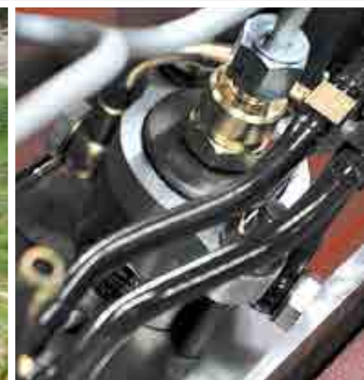
Efektivní využití paliva díky vstřikovacím tryskám s pěti otvory
