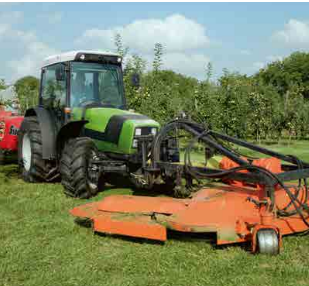
Se čtyřmi místy pro uchycení nářadí je práce v sadech a vinicích jednoznačně jednodušší
