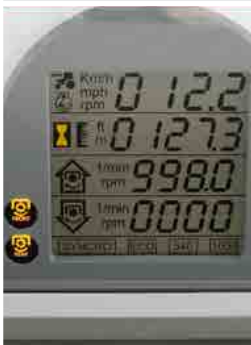
Aktivované otáčky vývodové hřídele se zobrazují na displeji
