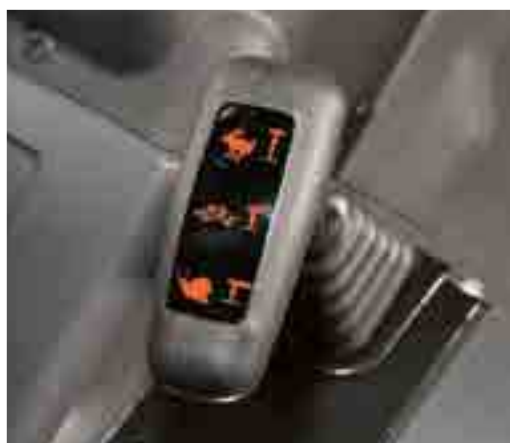
Díky třem rychlostním skupinám je k dispozici až 45 převodových stupňů
