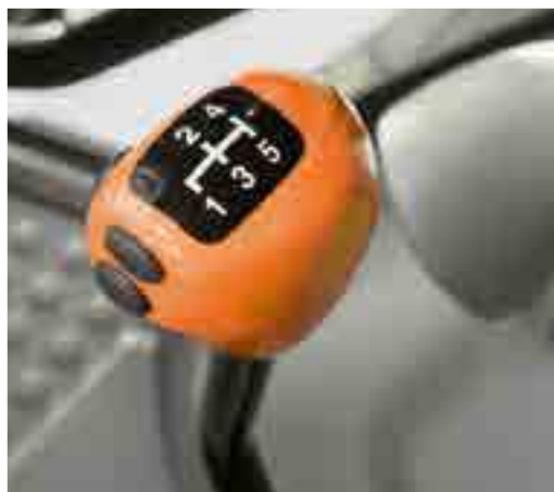
Stupně řazené pod zatížením lze řídit pohodlně prostřednictvím tlačítka umístěného na řídicí páce
