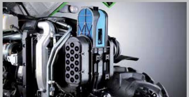
Nový vzduchový filtr PowerCore podporuje výkonost motoru...
