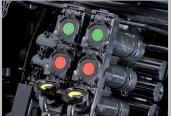
Nové hydraulické okruhy s vysokým průtokem dodávají vyšší výkon.
