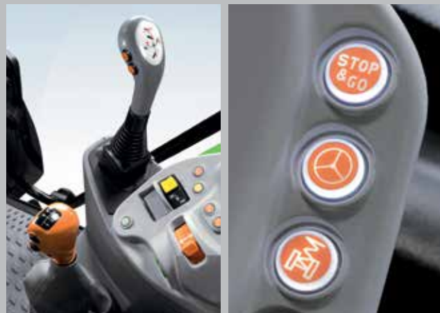
Joystick čelního nakladače s tlačítky Powershift, Stop&Go, systém rychlého řízení SDD...
