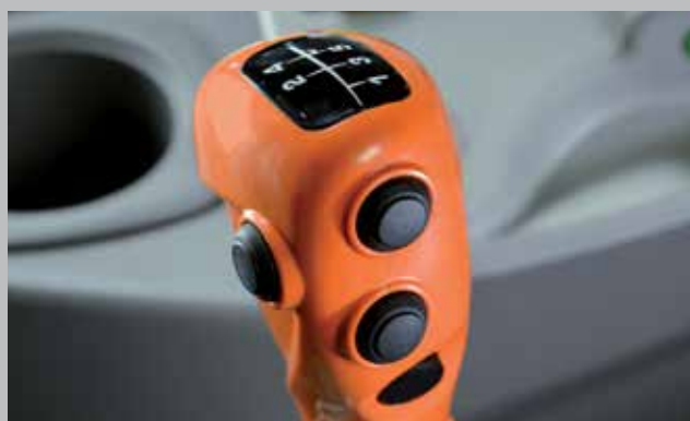
Řadící páka a Powershift. Jednoduché řazení stiskem tlačítka bez použití spojového pedálu.
