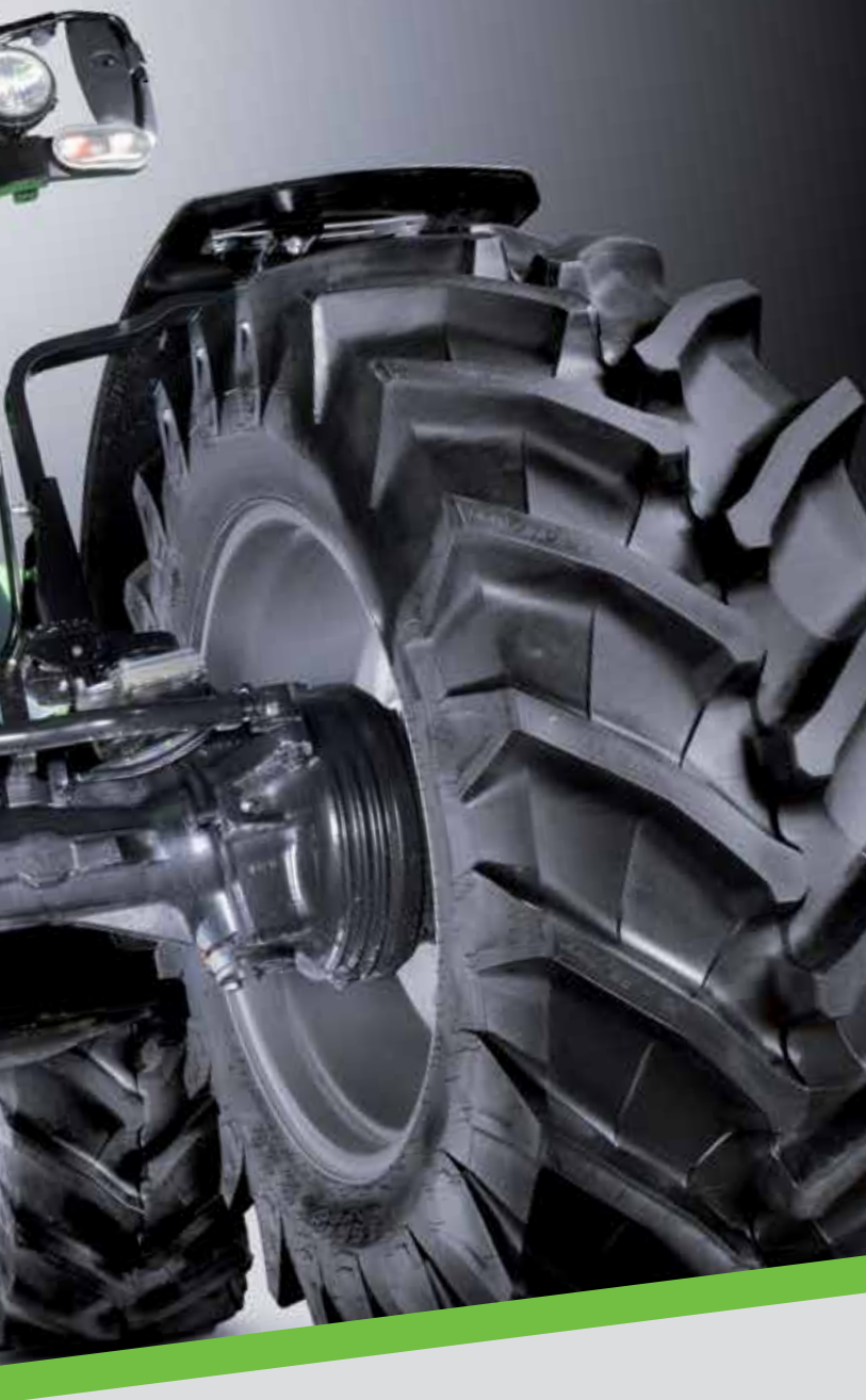
Unikátní bezpečnostní koncept od firmy DEUTZ-FAHR. Oddělené, olejem chlazené kotoučové brzdy na předních kolech.
