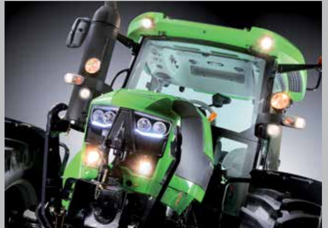
Ideální osvětlení pro optimální viditelnost při zhoršených podmínkách. Osm pracovních světlometů zabudovaných ve střeše a v bočních sloupcích. Dva pracovní světlomety a dva LED světlomety na kapotě.
