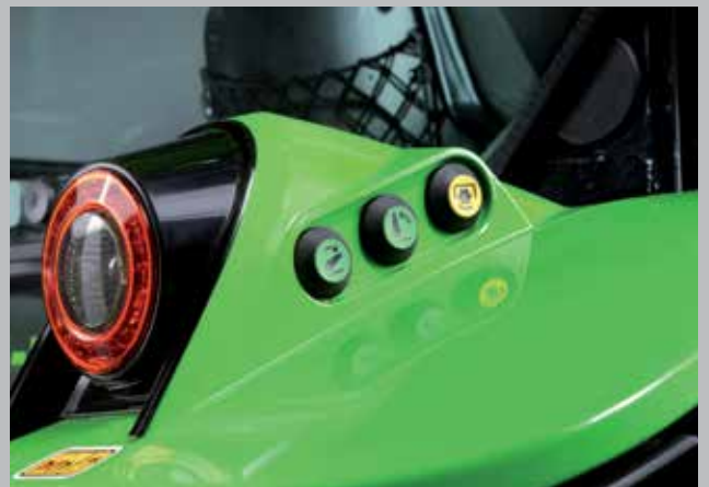
Externí ovládání vývodových hřídelí a tříbodových závěsů pro snadné upevnění a provoz přídatného zařízení.
