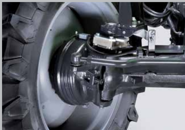
Unikátní bezpečnostní koncept od firmy DEUTZ-FAHR. Oddělené, olejem chlazené kotoučové brzdy na předních kolech.
