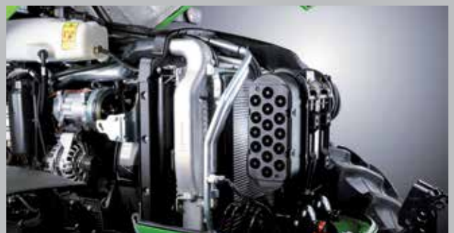
... stejně jako snadno čistitelný chladicí systém s volitelným viskózním ventilátorem.
