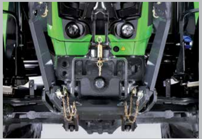
Přední tříbodový závěs. Zvedací kapacita 2100 kg a rychlost otáčení 1000 ot/min u vývodové hřídele.
