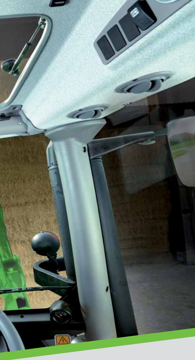
Joystick čelního nakladače s tlačítky Powershift, Stop&Go, systém rychlého řízení SDD...
