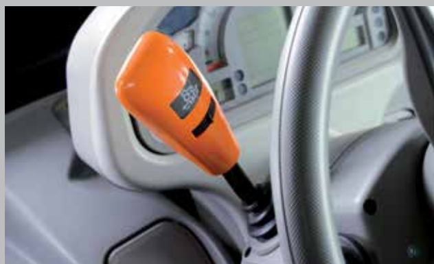
Powershuttle ve standardní výbavě. Elektrohydraulická reverzace s nastavitelnou agresivitou v pěti stupních.
