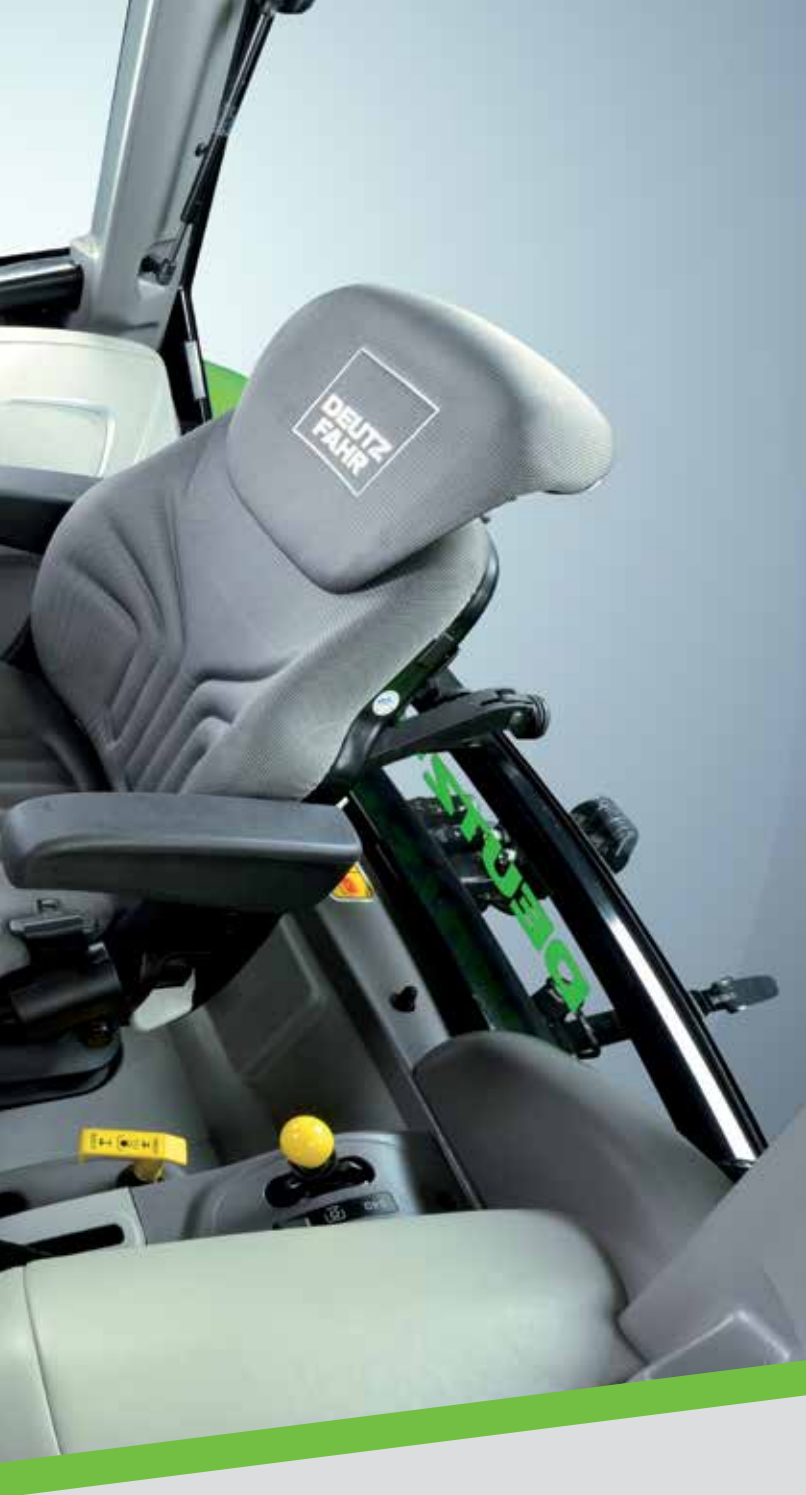
Vibrace v kabině snižené díky „hydro-silentblokům“.
