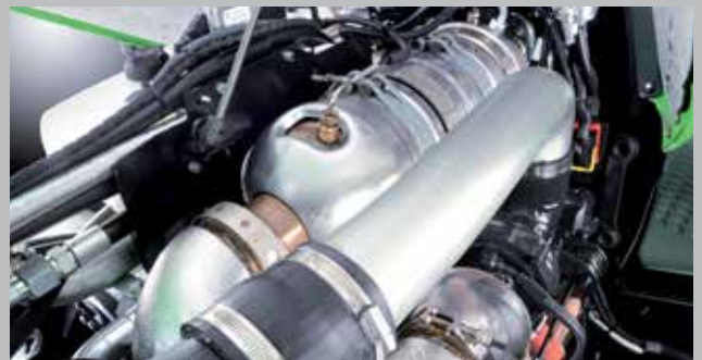
... a diesellový oxidační katalyzátor DOC, zajišťují minimální znečištění.
