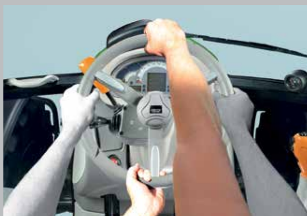
Systém rychlého řízení SDD. Poloviční počet otočení volantem, dvojnásobná síla řízení.
