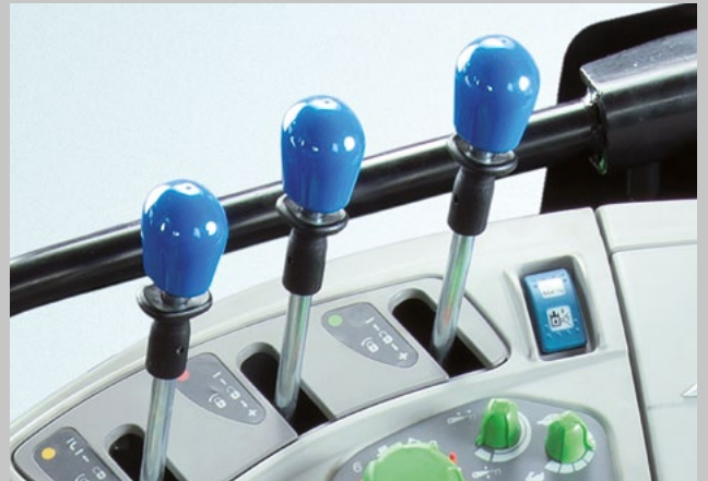
Ergonomické ovládání hydraulických okruhů - přesné, pohodlné a velmi spolehlivé.
