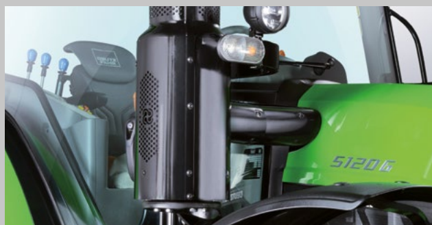
Výhodně umístěný SCR katalyzátor - nebrání výhledu.
