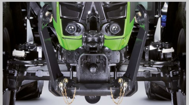
Přední tříbodový závěs a vývodová hřídel. Zvedací kapacita 2100 kg a rychlost 1000 ot/min.
