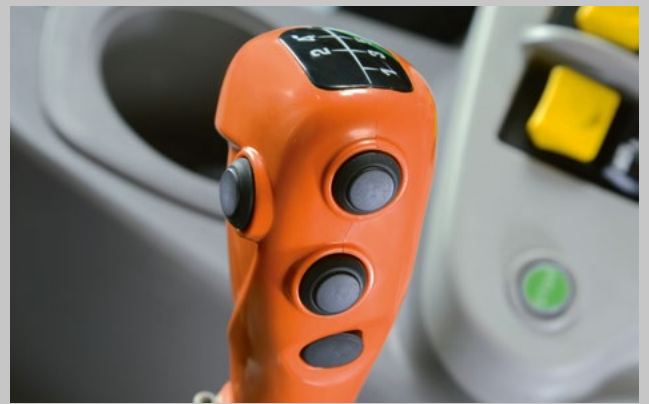
Pohodlná řadící páka s řazením pod zátěží. Jednoduché řazení hlavních převodů stiskem tlačítka bez nutnosti aktivace spojky.
