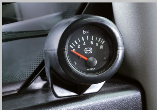
Systém vzduchových brzd (volitelně) pro spolehlivé brzdění těžkých přívěsů.
