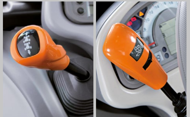
Mechanická reverzace (pod volantem) nebo Powershuttle s pěti nastavitelnými stupni agresivity – rozhodnutí je jen na Vás.
