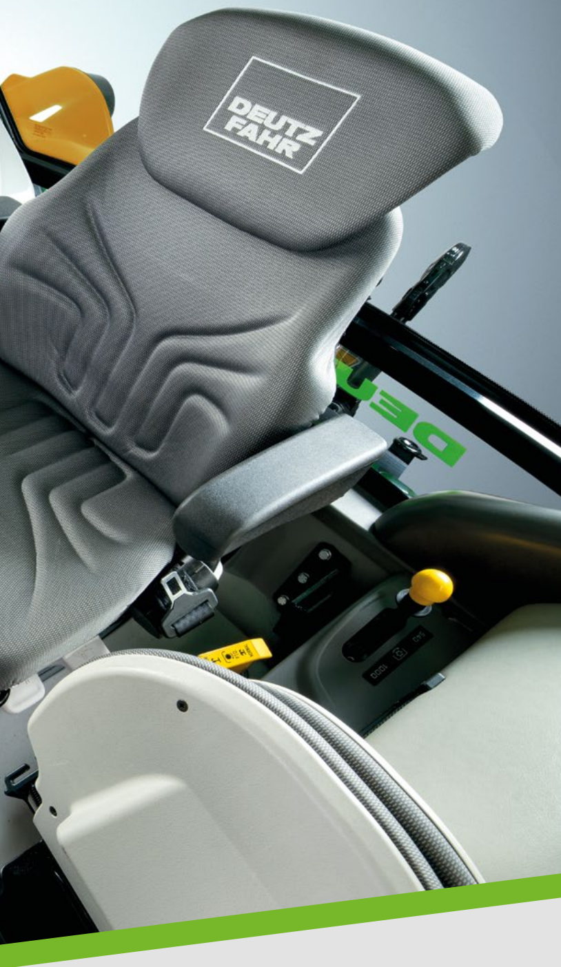
Snížení vibrací v kabině až o 40 %. Inovativní odpružení pomocí hydro-silentbloků.
