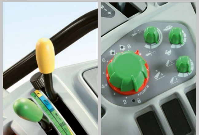
Mechanické nebo elektronické ovládání zadního tříbodového závěsu. Rozhodnutí je jen na Vás.
