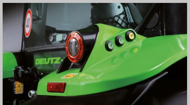
Externí ovládání vývodových hřídelí a tříbodových závěsů pro snadné zapojení a provoz přídatného zařízení.
