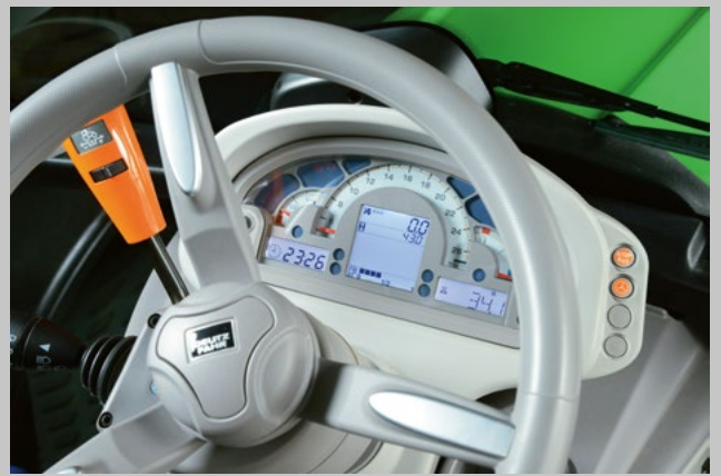
InfoCentre. Přehledné analogové a digitální zobrazení provozního stavu stroje.
