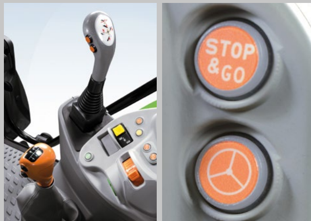
Plně integrovaný joystick čelního nakladače s tlačítky Powershift, Stop&Go, systému rychlého řízení SDD...
