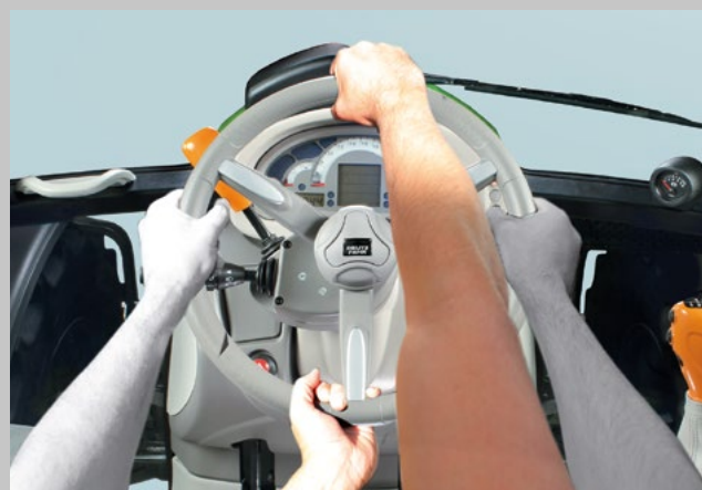
Systém rychlého řízení SDD. Poloviční otočení volantem, dvojnásobná rychlost otáčení kol.
