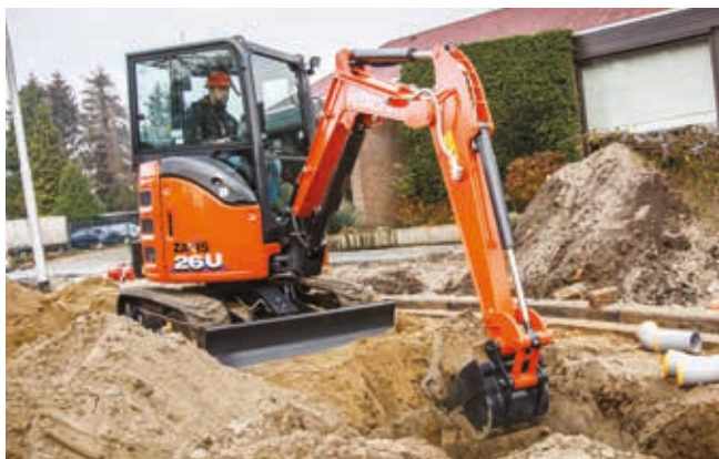
Příd' stroje je vybavena ochranným krytem válce výložníku pro zlepšení odolnosti.
