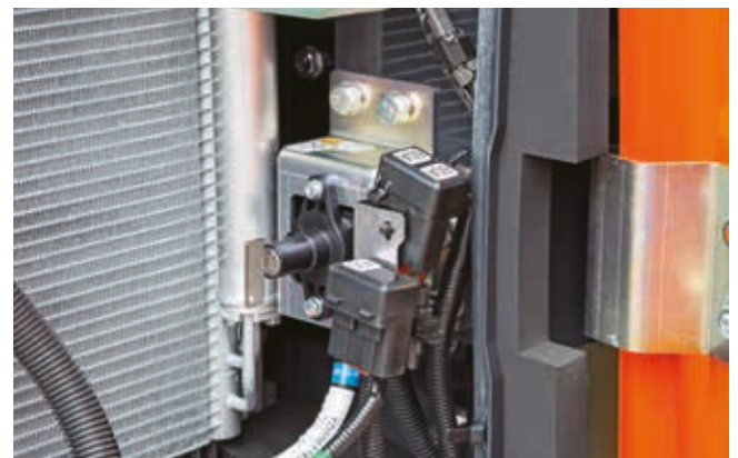
Odpojovací spínač akumulátoru umožňuje bezpečnou údržbu.
