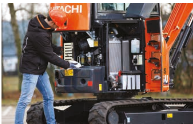
Snadno otevíratelné kryty umožňují rychlý přístup.
