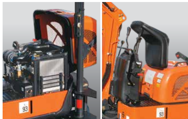
Kryty se širokými otvory umožňují snadno provádět údržbu stroje.
