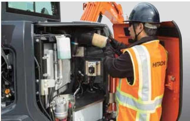
Snadno otevíratelné kryty umožňují rychlý přístup.
