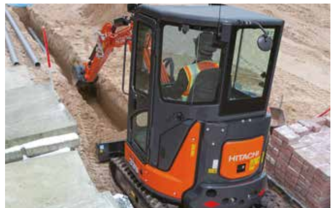
Krátký poloměr otáčení zadní části stroje ZX33U-6 je ideální pro práci ve stísněných prostorech.
