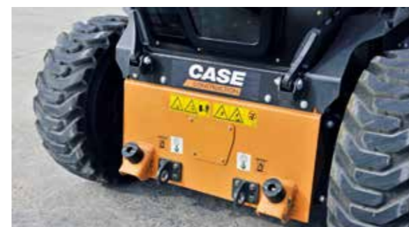
Tlačná síla díky zapření podvozku (šasi)
