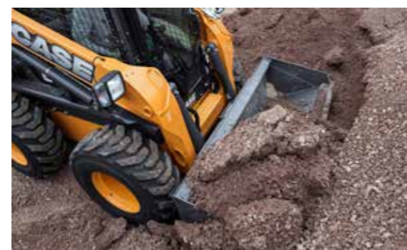
Tlačná síla díky zapření podvozku (šasi)
