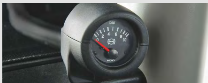
Manometr indikující tlak ve vzduchovém systému.
