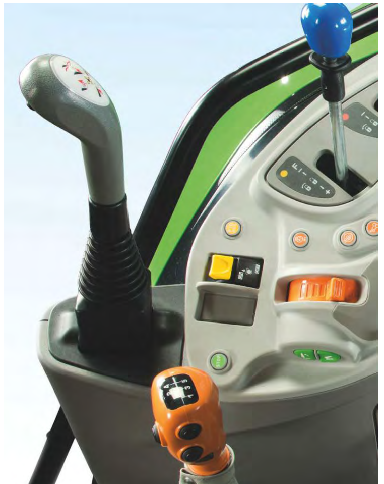
Joystick pro ovládání čelního nakladače dokonale integrovaný v pravém ovládacím panelu.
