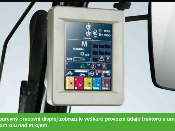
Antireflexní barevný pracovní displej zobrazuje veškeré provozní údaje traktoru a umožňuje plnou kontrolu nad strojem.
