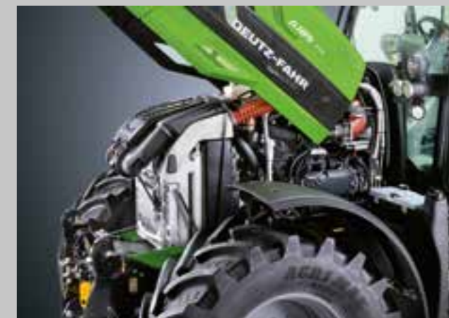
Vysoce výkonný a přitom velmi kompaktní chladicí systém sestávající z mezchladiče stlačeného vzduchu, vodního chladiče, chladiče převodového oleje, chladiče paliva a kondenzátoru klimatizace.
