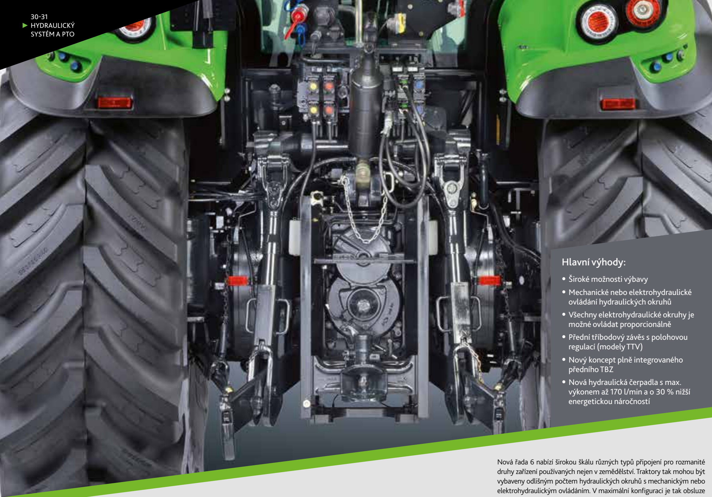
Nový přední tříbodový závěs s polohovou regulací (pouze u modelů TTV) a kapacitou zdvihu až 5 480 kg.
