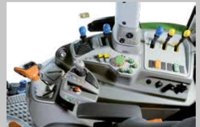
Powershift – převodovka s částečným řazením pod zátěží poskytuje efektivitu spojenou s manuálním řazením.
