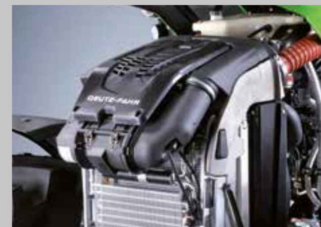
Vzduchové filtry s technologií PowerCore jsou o 20% výkonnější než klasické filtry a mají větší životnost.
