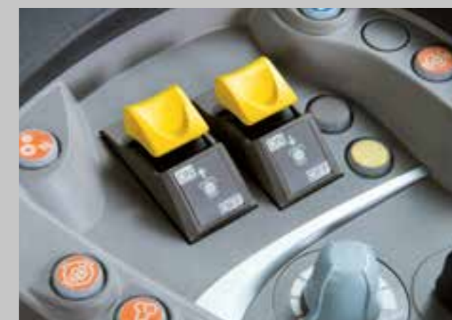
U všech verzí kabiny je spuštění vývodových hřídelí ovládáno jednoduše pomocí tlačítek.
