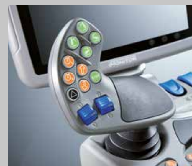
S maximální rychlostí 50 km/h jsou TTV modely řady 6 opravdu profesionální stroje. Pro dosažení vynikajících výsledků si může řidič pomoci dvěma tlačítky na ovládací páce vyvolat až 4 uložené rychlosti a udržovat je na konstantní úrovni.
