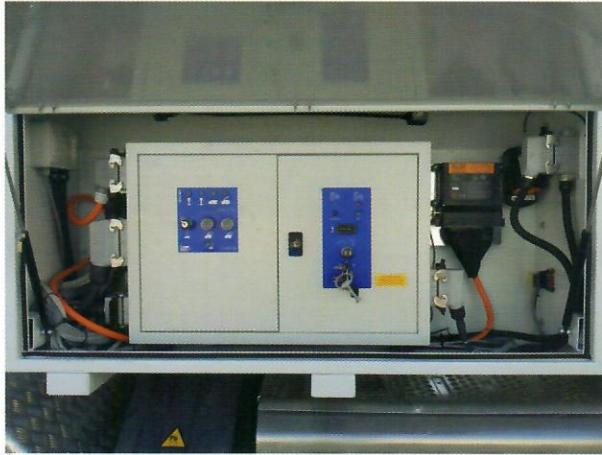
**Armadio elettrico integrato** con Radiocomando (unità trasmittente e ricarica) comandi a terra e vano per accessori
