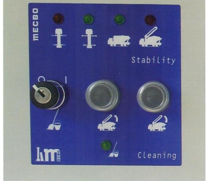
**Sistema** di stabilità "Full Operating range", conforme alla norma EN12001/2012
