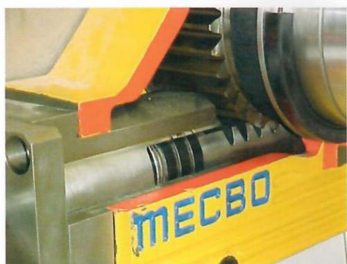
■ ■ Il gruppo pompante, solido e molto compatto, si inserisce perfettamente nella zona sotto stante la normale canala di scarico della betoniera e con la notevole capacità della trammoggia (lt. 600 circa), si può ricevere da altre betoniere, essendo l'altezza della stessa molto contenuta.
